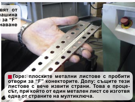
■ Къде отива сега платката? Разбира се, в една метална кутия. А откъде идват тези метални кутии? От тези машини за обработка на метални листове с размери 36 мм широчина и 0.7 мм дебелина с никелово покритие от 0.02 мм. Всяка нова ролка тежи около 100 кг и е дълга 400 м.
