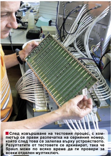
■ Всеки мултиключ се изпробва за различни функции. Той се поставя в тази тестова станция и със задвижване на един лост, всички "F" конектори се вкарват, след което се стартира процеса на тестване.
