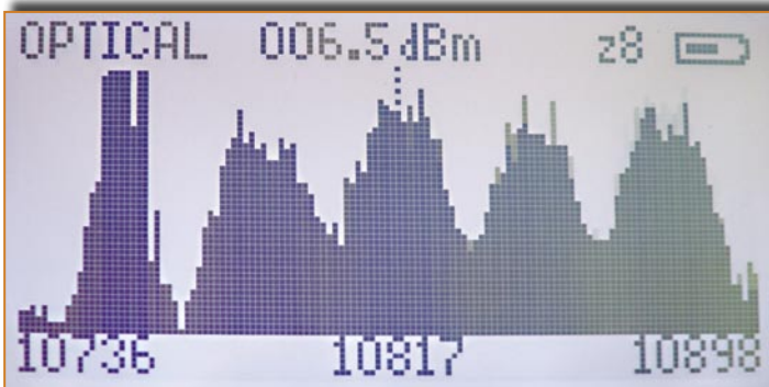
Показване на честотния спектър с вертикална поляризация на долния обхват при максимално увеличение |
