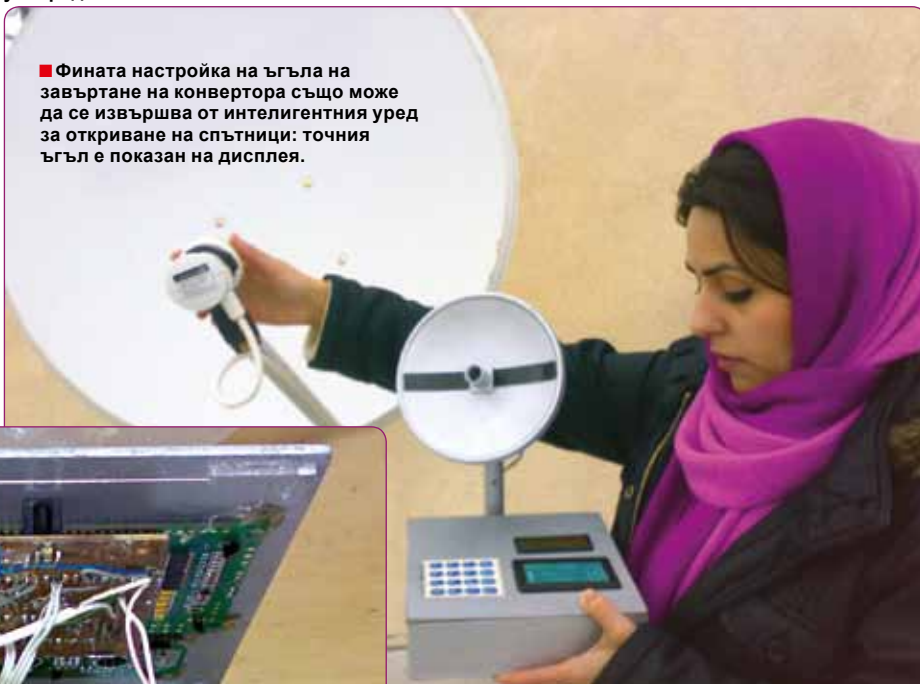
■ Ето как се използва интелигентния уред за откриване на спътници: малката антена показва позицията на спътниците, които ще се приемат, а реалната антена просто се поставя успоредно на нея.
