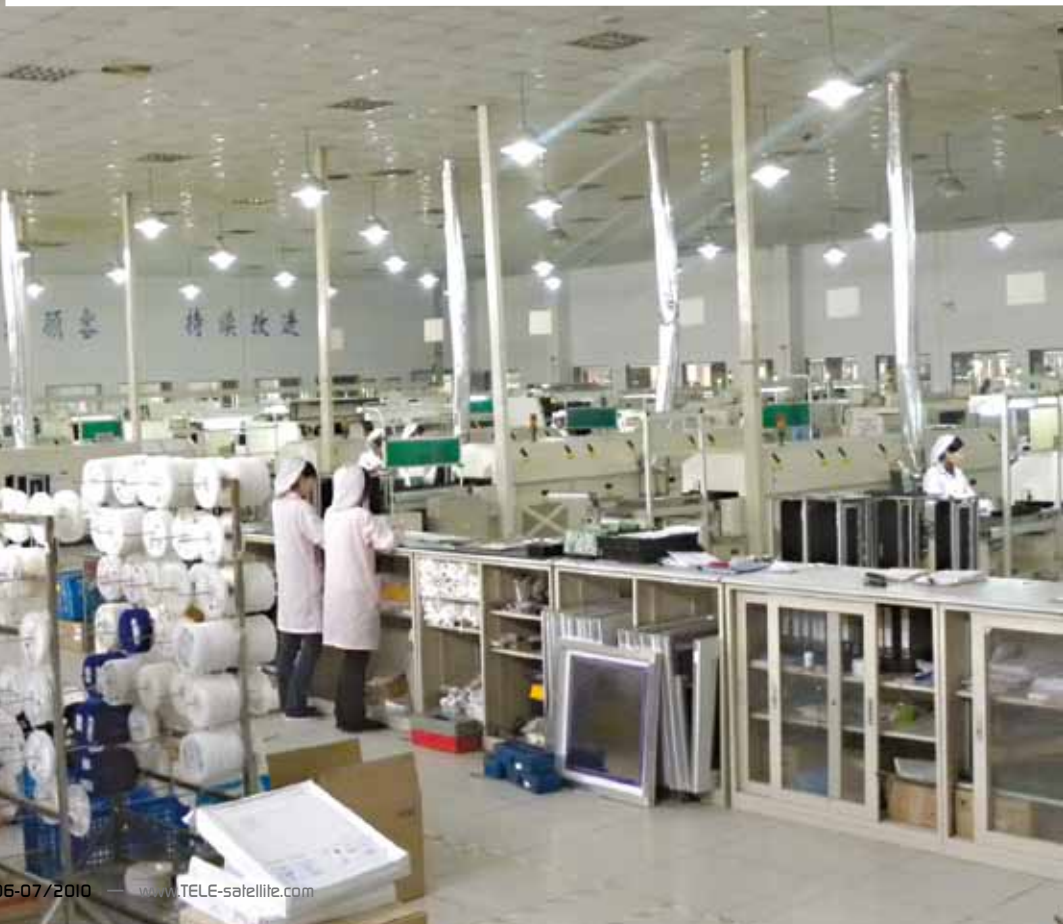
■ В другия край на залата се намират ролките със SMT компонентите, които непрекъснато се подават към автоматичните SMT машини от служител на компанията. Тези машини работят денонощно, без прекъсване. На стената отзад е написано: "Работете с Вашите колеги-приятели; Добро управление; С поглед към клиента; Непрекъснат прогрес".
